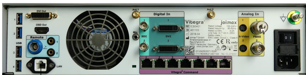
Figura 4: Parte traseira da unidade de controle Vitegra® — Porta de rede LAN
